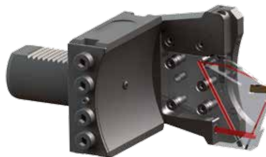
Modulares Stechsystem 960: Das rot dargestellte Kanalsystem zeigt, wie der Kühlschmierstoff gezielt an die Schneide geleitet wird: In diesem Fall durch den Spannfinger sowie als Unterstützungskühlung von unten.
