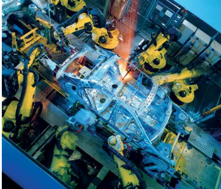
Ein Automobilwerk verbraucht pro Jahr so viel Energie wie eine mittelgroße Stadt – besonders der Energiehunger von Robotern ist unersättlich. Die Optimierung ihrer Bewegungen spart bis zu 50 Prozent Strom. Zur Steuerung der Fertigung hat Siemens das Automatisierungsportal Totally Integrated Automation (TIA) entwickelt.
