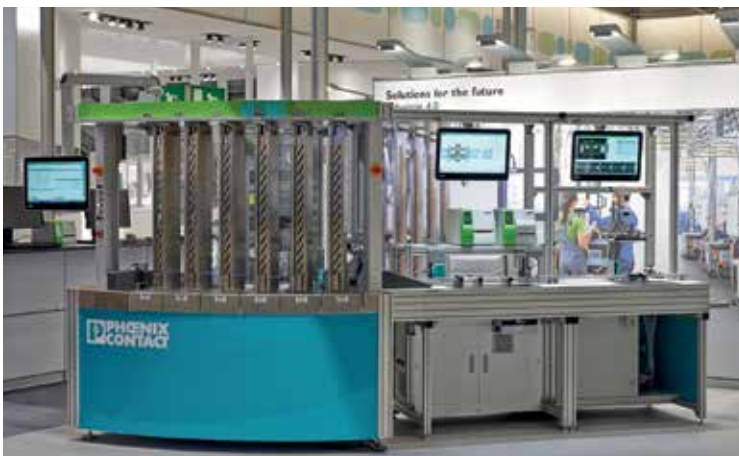
Beim Demonstrator von Industrie 4.0 handelt es sich um eine Beispiel- und Forschungsanlage für die Losgröße-1-Fertigung von Klemmenleisten.
